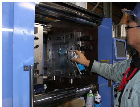
金型部品への給油
