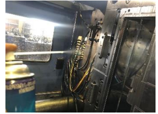
防錆剤のスプレー塗布
