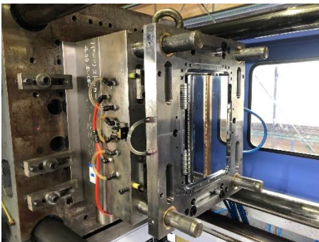
動作不良が生じた金型
