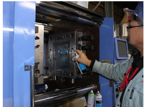
防錆剤の塗布中の様子
