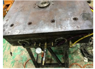
水漏れ確認中
