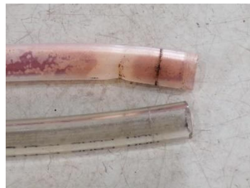
ホース部分損傷・劣化
