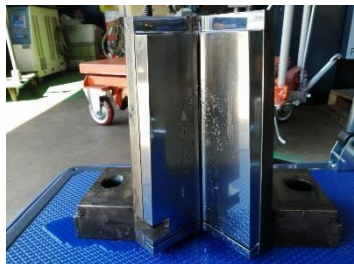
入れ子からの水漏れ
